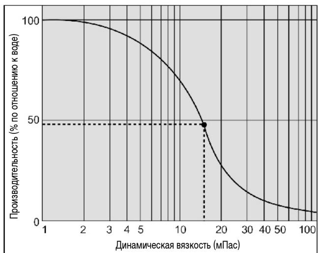
За 100% принята производительность помпы при перекачке воды
