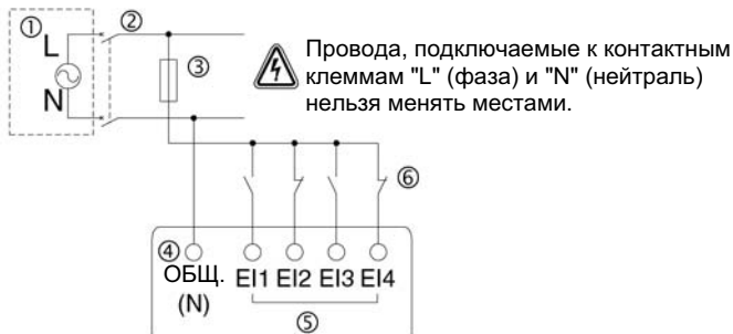
Рисунок 4.4: Схема электрических соединений с входными цепями, для ECC-PNAL2-4EX-A2
