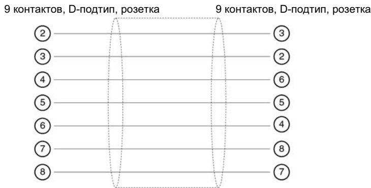
Рисунок 8.3. Схема перекрестного кабеля RS-232C, для справки
