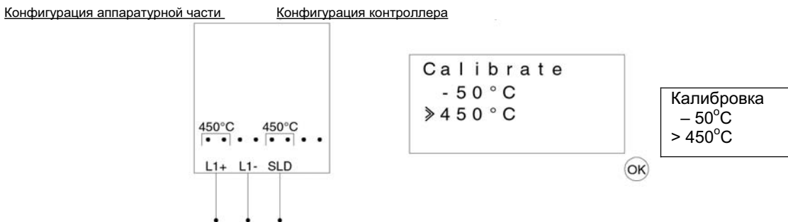
Рисунок 13.7: Регулировка коэффициента усиления в модуле AL2-2TC-ADP
