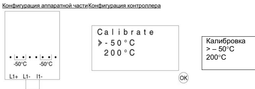
Рисунок 12.5: Регулировка смещения в модуле AL2-2PT-ADP
